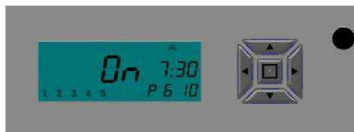
Si on veut accéder à la fonction alarme, appuyer sur la touche centrale ◻. Si l'alarme est OFF (l'écran affiche OFF), automatiquement l'écran s'allume et l'heure s'affiche en clignotant. Si l'alarme est ON à l'écran s'affiche ON en clignotant. Appuyer sur la touche de droite (►) pour que l'heure commence à clignoter. Pour la programmation suivre les instructions suivantes :
